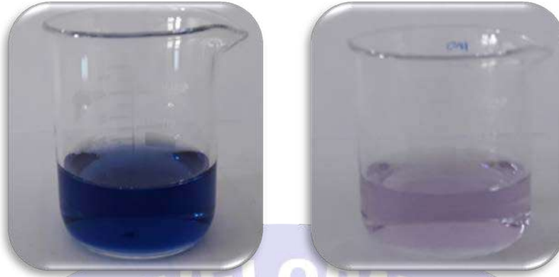
Şekil 4. Reaktif Black 5 boyasının nanobiyosorbent madde ile fenton reksiyonu (KAD) ile etkileşimi sonucu boyada meydana gelen değişimler
