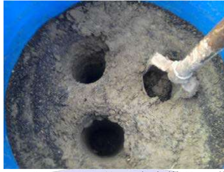
Şekil 2.4 Deneme kaplarından 0-20, 20-40 ve 40-60cm derinlikten çelik toprak alma bulgusu ile 3 farklı noktastan alınan örnek görüntüsü.
