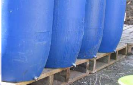
Şekil 2.2 Deneme kabının alt kısmı drenaj borusu ile hazırlanması ve üzerine mıcır ilave edilmesi.
