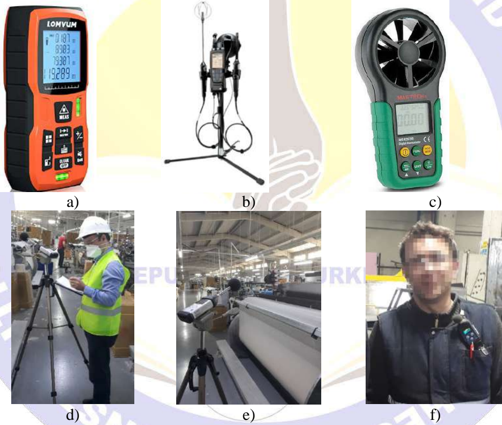
Şekil 3. Fiziki ortam şartları ölçme araçları, ortam gürültü ölçümleri ve kişisel maruziyet ölçümleri a)Lazer metre, b)Dijital sıcaklık nem basınçölçer, c)Anemometre, d)Ölçüm aşamasında KKD kullanımı e)Ortam gürültü ölçümü f)Gürültü kişisel maruziyet ölçümü.
