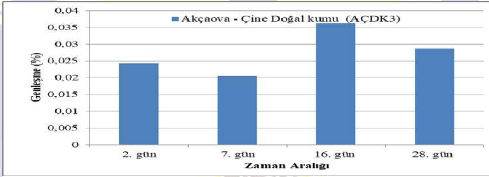
Şekil.6 Akçaova - Çine Doğal kumu (AÇDK 3 ) ASR Genleşme Değerleri Grafiği
